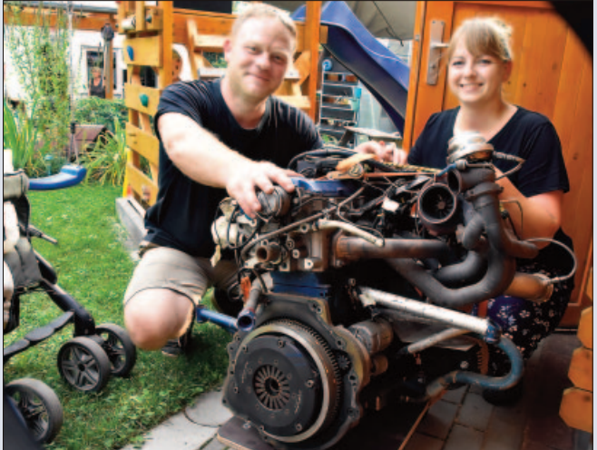
■ Herzstück wird dieser von 180 PS auf 500 PS getunte Ex-VW-Golf-Motor sein.
